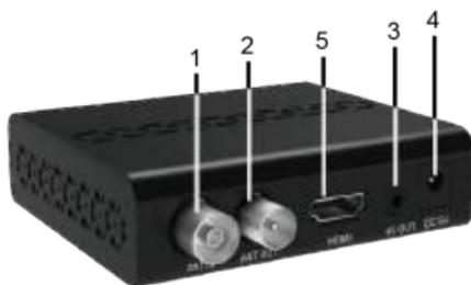
1. **RF IN:** Разъем для подключения внешней эфирной антенны.
