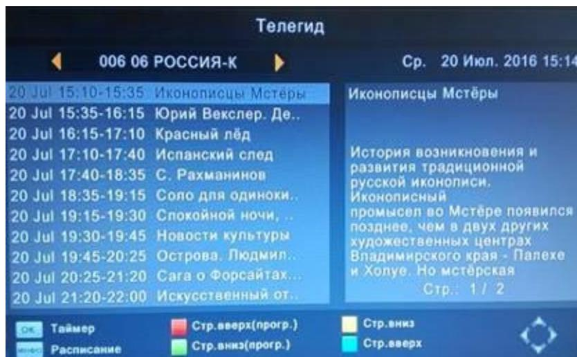
Выберите нужную передачу и нажмите кнопку **[OK]** для включения **Таймера**. Для просмотра текущего Расписания нажмите кнопку **[ИНФО]**. Подробнее о функции **Таймер** и **Расписание** смотрите пункт 7.11. **Расписание** (стр.21).
